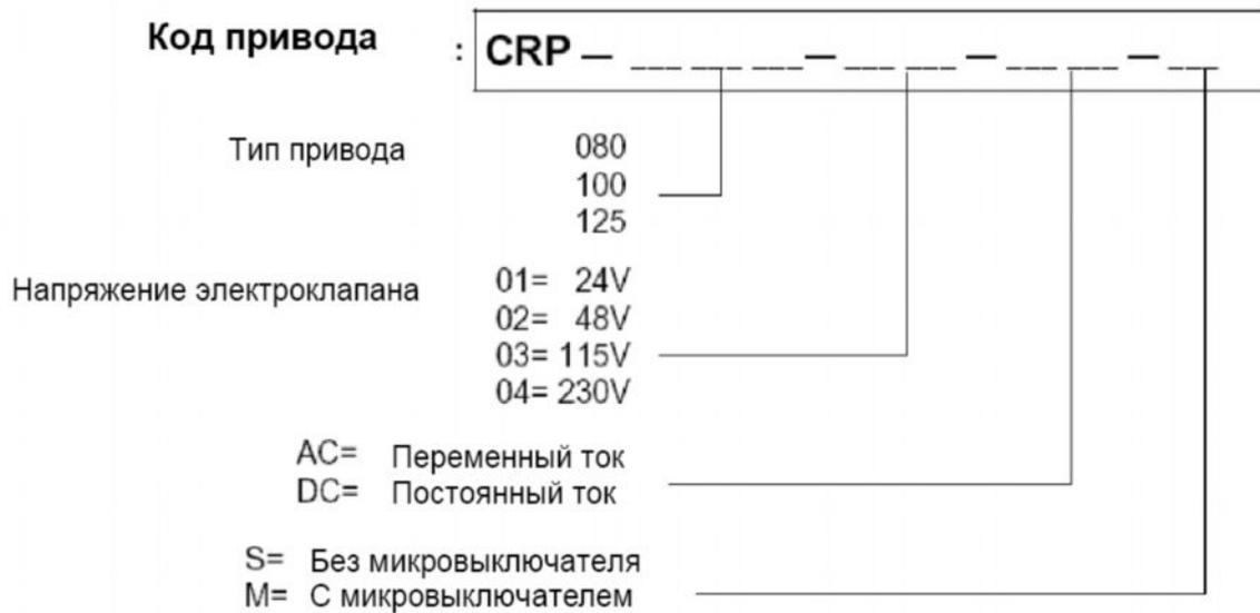
**Электроклапаны для привода CRP в комплекте с катушками для переменного тока**
